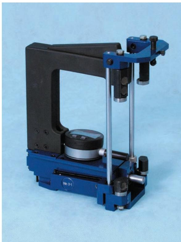
Нутромер модели 4153 предназначен для измерения диаметра отверстий ступиц железнодорожных колес.
