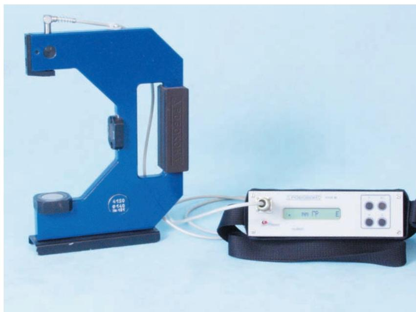
Скоба измерительная модели 4150M-D предназначена для измерения наружного диаметра цилиндрических деталей: колец подшипников, шеек валов, осей и т.п. с их сортировкой на размерные группы для последующей селективной сборки.
