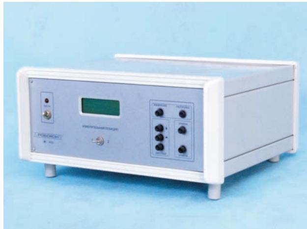
Прибор модели 4152-Л предназначена для измерения среднего диаметра и формы отверстия в трех сечениях по высоте внутренних колец подшипников, а также для сортировки колец на размерные группы по среднему диаметру для последующей селективной сборки.
