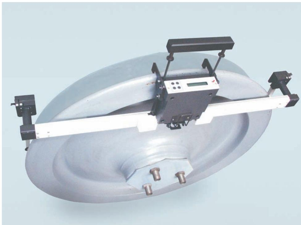
Прибор модели 4160У предназначен для измерения диаметра круга катания железнодорожных колес на всех стадиях технологического процесса, кроме измерения без выкатки тележки из под подвижного состава.
