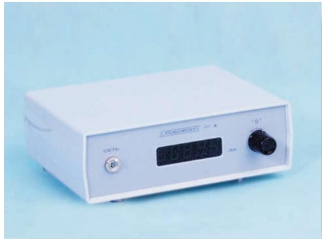
Прибор модели 4151 предназначен для измерения внутренних и наружных диаметров в двух сечениях деталей типа колец, с переворотом измеряемой детали.
