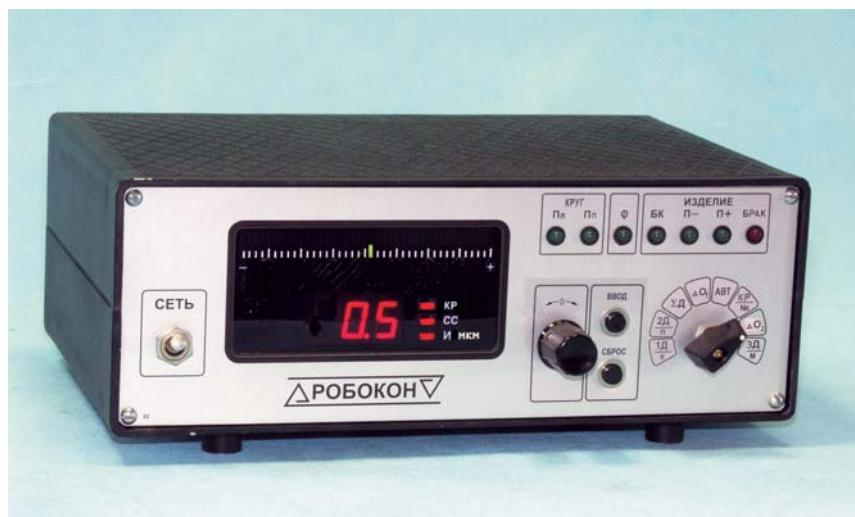
Прибор модели ПКП7М предназначен для подналадки станка по результатам контроля диаметра деталей типа поршневых пальцев и роликов подшипников непосредственно после выхода из зоны обработки.
