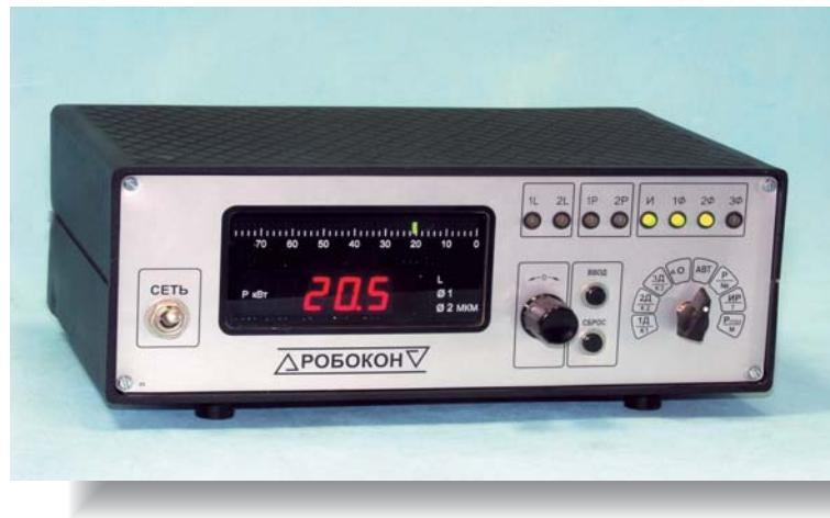
Прибор мод. ПКУ136-1 и его модификации предназначены для управления процессом осевой ориентации торцовой поверхности детали относительно режущей кромки шлифовального круга и управления циклом шлифования по результатам контроля диаметра обрабатываемой поверхности.
