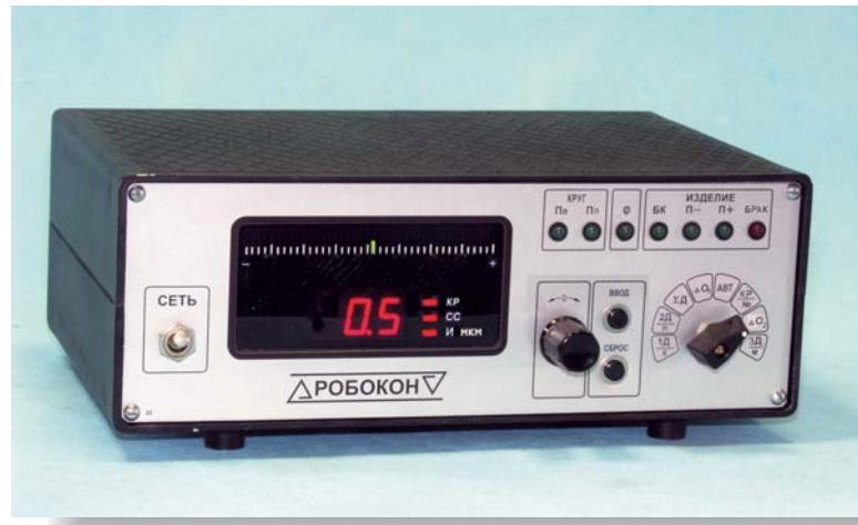
Прибор модели ПКП5М предназначен для подналадки станка по результатам контроля диаметра наружной цилиндрической поверхности деталей типа колец подшипников непосредственно после выхода из зоны обработки.
