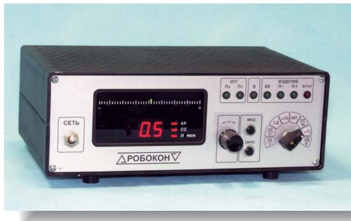
Прибор модели ПКП8 предназначен для подналадки станка по результатам контроля диаметра конических роликов на заданном расстоянии от базового торца при движении роликов «в столбе» после выхода их из зоны обработки.
