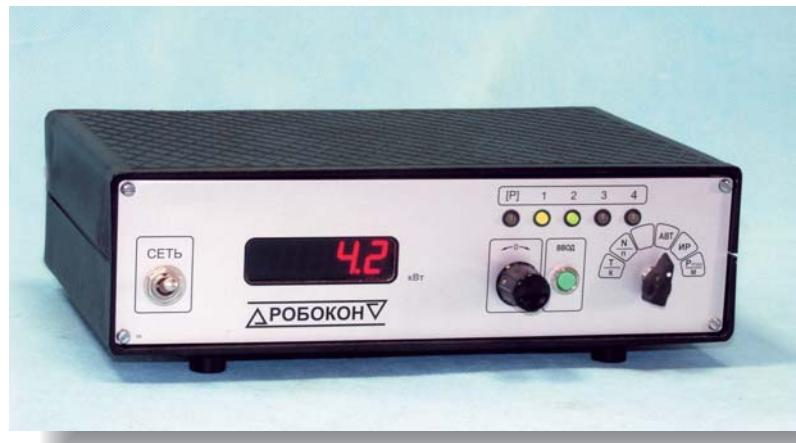
Прибор мод. ПКМ2 предназначен для управления циклом шлифования по результатам контроля мощности резания, а также для формирования команды на правку шлифовального круга при уменьшении его режущей способности до заданного уровня.
