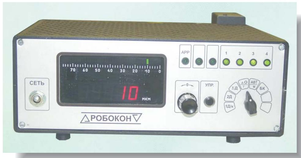
Прибор мод. ПКУ67МЭ предназначен для управления циклом хонингования отверстий деталей типа гильз цилиндров двигателей по результатам контроля диаметра обрабатываемого отверстия.
