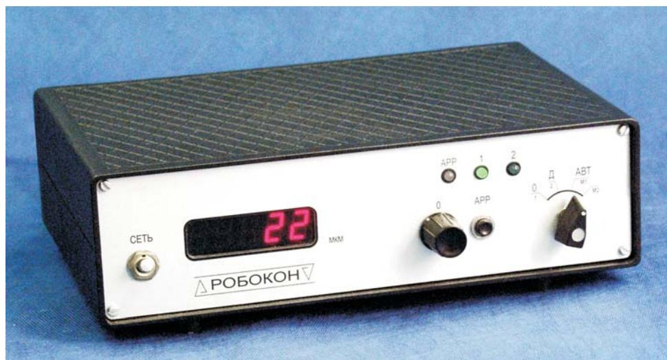
Приборы мод. ПКУЗ1 предназначены, в зависимости от применяемой наладки, либо для контроля ширины владины между зубьями шлицевого вала, либо для контроля внутреннего диаметра (радиуса) шлицевого вала прямобочного профиля.
