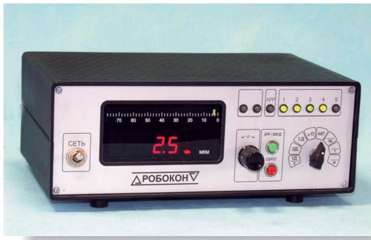
Прибор мод. ПКУ123 предназначен для управления циклом шлифования плунжера по результатам одновременного контроля диаметра обрабатываемой поверхности и диаметра отверстия во втулке плунжера, сопрягаемой с обрабатываемой деталью.
