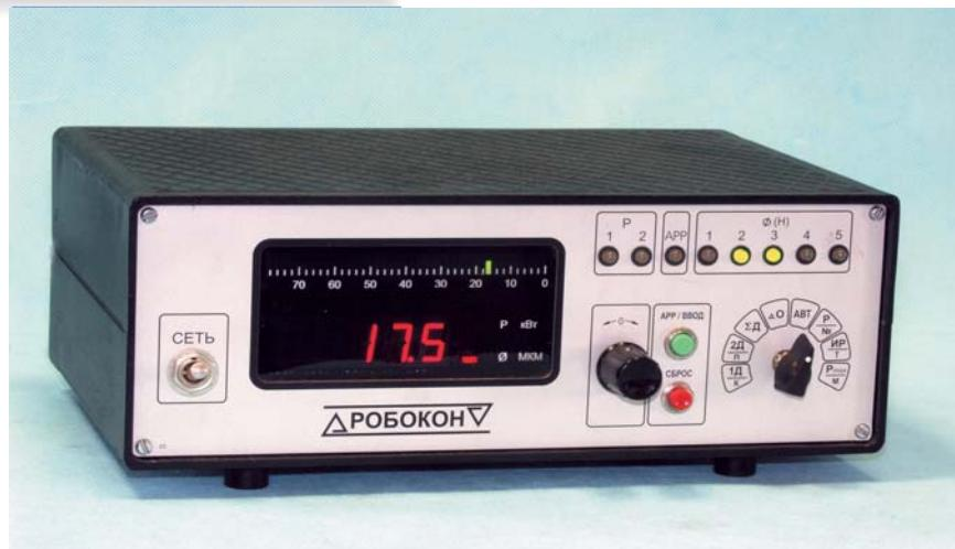
Прибор мод. ПКУ126 -1 предназначен для управления циклом шлифования по результатам контроля диаметра обрабатываемой поверхности детали.
