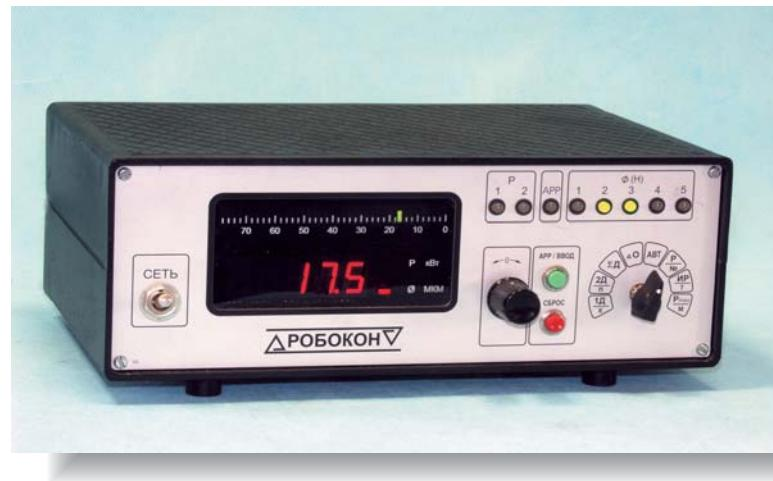
Приборы мод. ПКУ138-1 и ПКУ140-1 предназначены для управления циклом шлифования по результатам контроля диаметра или расстояния между торцами обрабатываемой гладкой (прибор ПКУ138-1) или прерывистой (прибор ПКУ140-1) поверхности детали.
